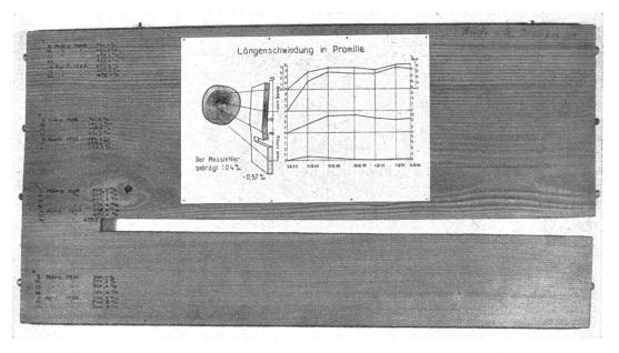
Bild 2. Ungleiche Längenschwindung des buchsigen und nichtbuchsigen Teiles eines Tannenbrettes vom frischen zum lufttrockenen Zustand.
