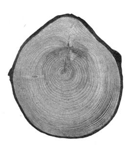
Bild 4. Trockenrisse an Fichte. (Aus: "Holzfehler".)
