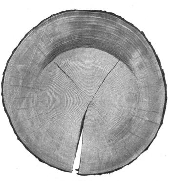
Bild 1. Der Buchs oder das Rotholz der Nadelhölzer. (Aus Knuchel: "Holzfehler".)
