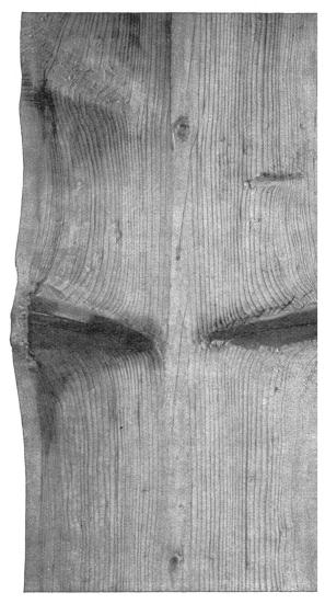
Bild 10. Verschlechterung der Holzqualität infolge von nicht sachgemäss ausgeführter Astung.
