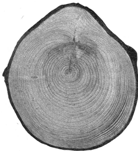
Bild 4. Trockenrisse an Fichte.
