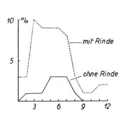
Abb. 9. Ersticken (Vermorschung) berindeter und entrindeter Fichtenstämme von verschiedener Fällungszeit bei einjähriger Lagerung im Freien. (Nach Gäumann, 1930.)
