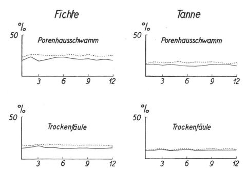
Abb. 14. Die Vermorschung von 1 Jahr ausgewettertem Fichtenund Tannenholz von verschiedener Fällungszeit bei konstanter Temperatur und konstanter Feuchtigkeit durch den Porenhausschwamm (Polyporus vaporarius) und durch den Erreger der Trockenfäule (Coniophora cerebella). Einwirkungsdauer der Pilze 6 Monate. Punktierte Kurve: Splint. Ausgezogene Kurve: Kern. (Nach Gäumann, 1930.)
