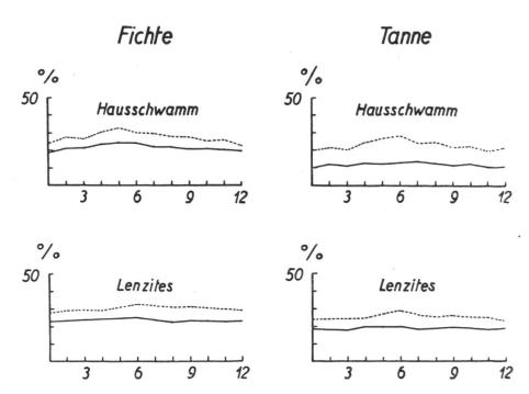
Abb. 11. Die Vermorschung von 1 Jahr trocken gelagertem Fichten- und Tannenholz von verschiedener Fällungszeit bei konstanter Temperatur und konstanter Feuchtigkeit durch den echten Hausschwamm (Merulius domesticus) und durch Lenzites abietina. Einwirkungsdauer der Pilze 6 Monate. Punktierte Kurve: Splint. Ausgezogene Kurve: Kern. (Nach Gäumann, 1938.)
