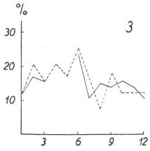
Abb. 4. Prozentuale Auflösung einiger Wandbestandteile der Tanne von verschiedener Fällungszeit. Kurve 1: Pentosane durch Lenzites abietina in 3 Monaten. Kurve 2: Zellulose durch Merulius domesticus in 6 Monaten. Kurve 3: Lignine durch Merulius domesticus in 6 Monaten. Ausgezogene Kurve: Kern. Punktierte Kurve: Splint. (Nach Gäumann, 1930 und 1932.)
