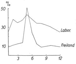
Abb. 1 a. Die laboratoriumsmässige und die tatsächliche Vermorschung von waldfeuchtem Fichtensplint aus den verschiedenen Fällungsmonaten. (Nach Gäumann, 1930.)
