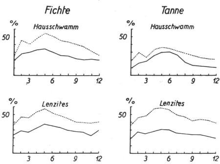
Abb. 1 b. Die Vermorschung des waldfeuchten Fichten- und Tannenholzes von verschiedener Fällungszeit bei konstanter Temperatur und konstanter Feuchtigkeit durch den echten Hausschwamm (Merulius domesticus) und durch Lenzites abietina. Einwirkungsdauer der Pilze 3 Monate. Punktierte Kurve: Splint. Ausgezogene Kurve: Kern. (Nach Gäumann, 1938.)
