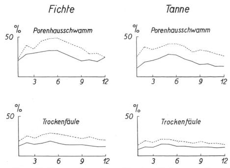
Abb. 2. Die Vermorschung des waldfeuchten Fichten- und Tannenholzes von verschiedener Fällungszeit bei konstanter Temperatur und konstanter Feuchtigkeit durch den Porenhausschwamm (Polyporus vaporarius) und durch den Erreger der Trockenfäule (Coniophora cerebella). Einwirkungsdauer der Pilze 3 Monate. Punktierte Kurve: Splint. Ausgezogene Kurve: Kern. (Nach Gäumann, 1930.)
