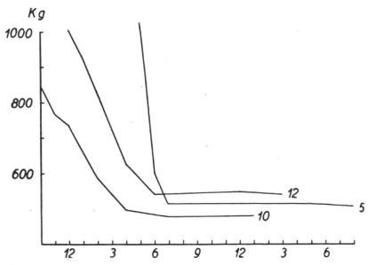
Abb. 7. Wasserverlust von Fichtenkern aus verschiedener Fällungszeit bei Lagerung unter Dach. (Nach H. Knuchel, 1930.)
