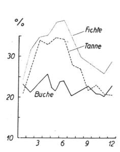
Abb. 15. Die Vermorschung von Fichtenkern, Tannenkern und Buchenkern aus verschiedenen Fällungszeiten durch den Porenhausschwamm (Polyporus vaporarius).
