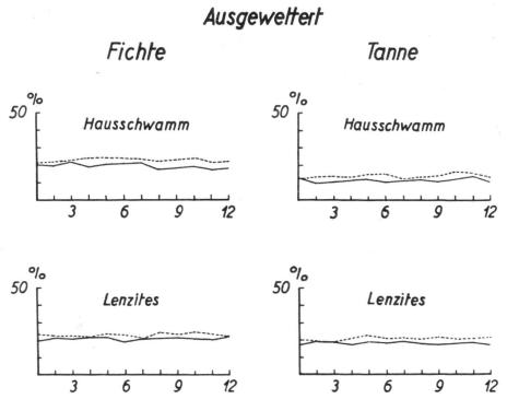
Abb. 13. Die Vermorschung von 1 Jahr ausgewettertem Fichtenund Tannenholz von verschiedener Fällungszeit bei konstanter Temperatur und konstanter Feuchtigkeit durch den echten Hausschwamm (Merulius domesticus) und durch Lenzites abietina. Einwirkungsdauer der Pilze 6 Monate. Punktierte Kurve: Splint. Ausgezogene Kurve: Kern. (Nach Gäumann, 1938.)
