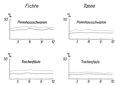
Abb. 12. Die Vermorschung von 1 Jahr trocken gelagertem Fichten- und Tannenholz von verschiedener Fällungszeit, bei konstanter Temperatur und konstanter Feuchtigkeit durch den Porenhausschwamm (Polyporus vaporarius) und durch den Erreger der Trockenfäule (Coniophora cerebella). Einwirkungsdauer der Pilze 6 Monate. Punktierte Kurve: Splint. Ausgezogene Kurve: Kern. (Nach Gäumann, 1930.)
