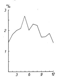
Abb. 8. Prozentuales Schwinden von Fichtenkern aus verschiedener Fällungszeit. (Nach Knuchel, 1930.)
