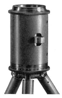
als ein zylindrisches Rohr, mit Dosenlibelle und vier genau rechtwinklig gefrästen Visierschlitzen versehen — dient zum Abstecken von rechten Winkeln in kupiertem Gelände. Das interessanteste Modell ist die Winkeltrommel, welche nebst der Vorrichtung zum Abstecken rechter Winkel im Deckel einen Flüssigkeitskompass trägt. Mit diesem können kleine Kompasszüge ausgeführt werden. Die Magnetnadel bewegt sich in einer Flüssigkeit, wodurch
