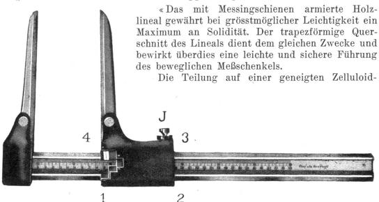
platte gestattet ein leichtes und müheloses Ablesen, unterstützt durch einen deutlich sichtbaren Index als Nullpunkt.
