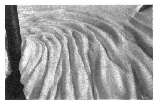
Abb. 13. Verfältelung einer Neuschneeschicht beim Abgleiten auf einem Blechdach (Bildung in wenigen Minuten).
