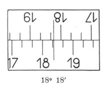
dem genannten System abgebildeten Stellen des Höhenkreises beim Wildschen Bussolentheodolit wieder. Die untere Bildhälfte ist aufrecht und die Zahlen wachsen von links nach rechts. Die obere Hälfte ist seiten- und höhenverkehrt, die Zahlen wachsen von rechts nach links. Will man nun die Kreisbilder nach bekannten Methoden ablesen, so zieht man sich vorerst einen Strich als Index, der ungefähr in der Mitte zwischen
