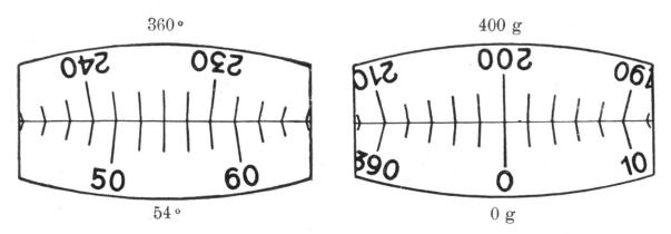
Ablesebeispiele für Bussolenkreis; die einzelnen Minuten werden am Mikrometer abgelesen.
