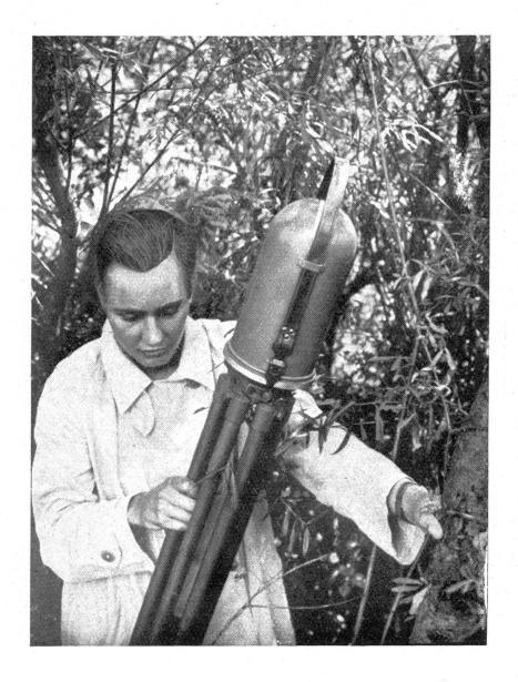
Da das kleine Instrument beim Feldgebrauch sehr oft mit dem Stativ vorgetragen wird, kann es durch Aufsetzen der Haube gegen alle Beschädigungen und gegen Wasser und Staub vollständig geschützt werden, eine Massnahme die der Förster besonders zu schätzen weiss.
