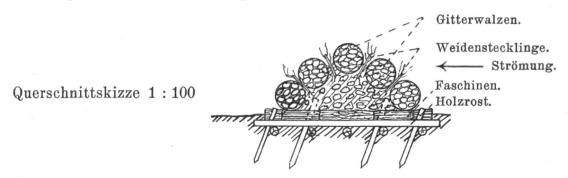
Der Sporn misst zirka 70 m³, ohne Holz- und Faschinenunterlage. Die gesamten Erstellungskosten, einschliesslich Ankauf der Drahtgitter, belaufen sich auf Fr. 1062.
