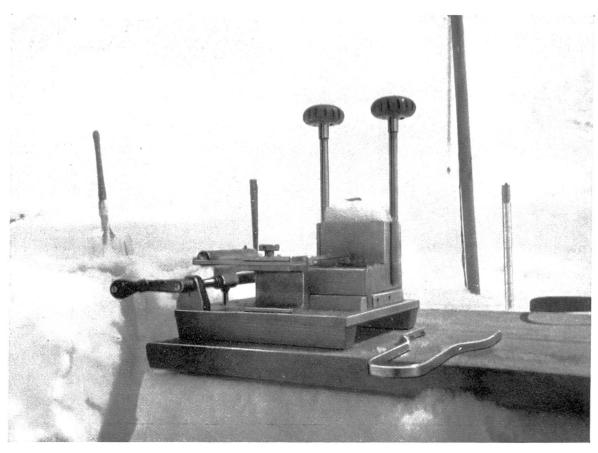
Abb. 6. Photo Oechslin. Die Schneeröhre wird im Klemmtisch festgemacht und mit der Waage verbunden.
