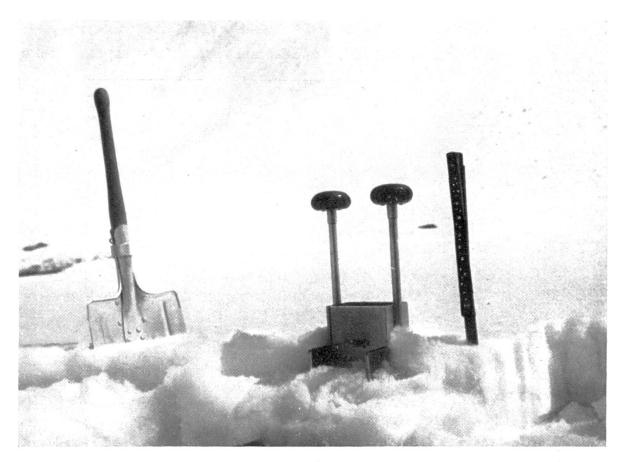
Abb. 5 Schneekohäsions-Messinstrument Oechslin. Mit der Schneeröhre wird der Schnee ausgestochen.
