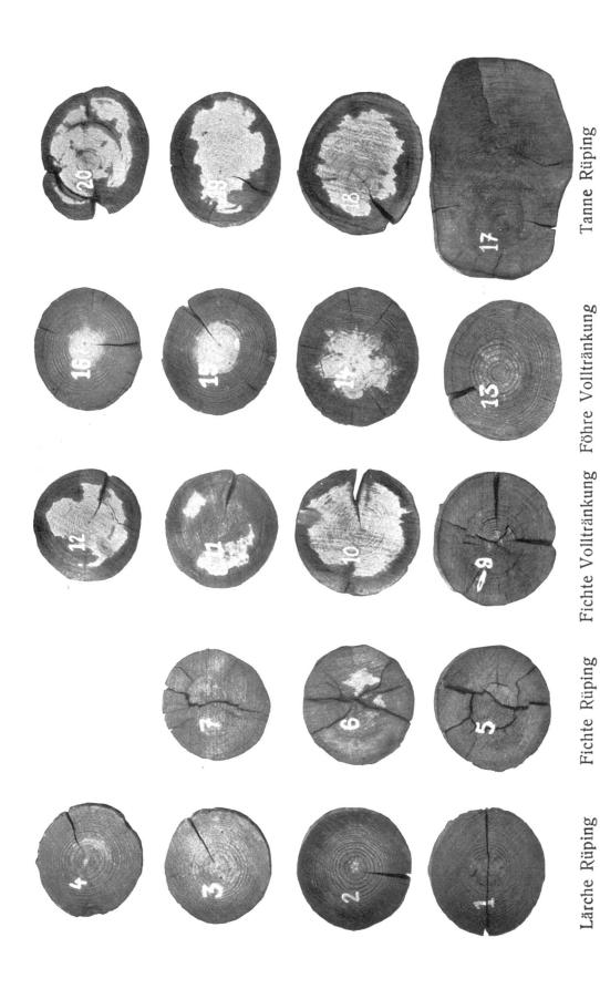
Tafel IV. Teeröl-Imprägnierung. Stangen eingegraben 1908, ausgegraben 1934.
