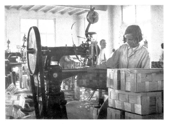
Abb. 3. Die Heftmaschine zum Anbringen der Agraffen.
