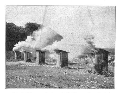
Abb. 7. Die erste Serie nach 10 Minuten Branddauer.
