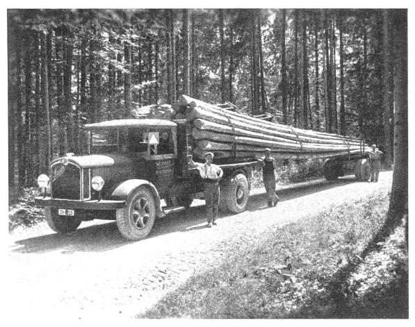
Abb. 4. Krebs, 1934. Holzabfuhr auf der neuen Waldstrasse im Sihlwald. Lastwagen mit 40 Stangen mit total 13,5 fm Inhalt.
