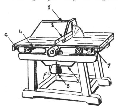
werden nicht selten fehlerhaft gebaut. An der Landmaschinenschau in Burgdorf wiesen nicht weniger als drei der ausgestellten Maschinen grobe Mängel auf. Zur Orientierung des Fabrikanten undKäufers einer Brennholzfräse fassen wir die Forderungen, die mindestens erfüllt sein müssen, zu-Die landwirtsammen. schaftliche Brennholzfräse (Kreissäge) muß wenigstens folgende Schutzvorrichtungen aufweisen:
