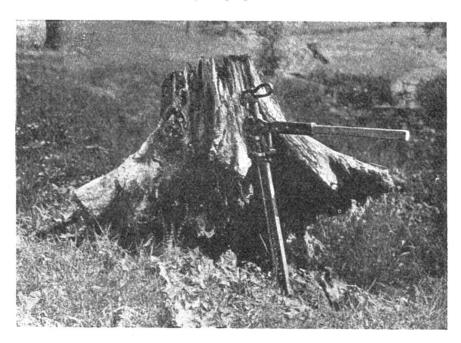
Ohne der Prüfung vorzugreifen, wollen wir hier nur auf das in allen Teilen wohldurchdachte neue Gerät aufmerksam machen, dessen Konstruktion und Verwendungsmöglichkeit aus unsern Abbildungen hervorgeht. Die Handyman-Winde hat eine Hebekraft von 3 Tonnen. Sie wird in drei Längen, nämlich 81, 122 und 162 cm, entsprechend einem Gewicht von 11—13,6 kg, geliefert. Knuchel.
