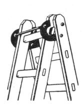
Bauart Vorteile auf. Die Leiter besteht aus zwei Teilen, die entweder zusammengesteckt und als gewöhnliche Leiter, oder geklappt als Bockleiter benutt werden können. Holmen und Sprossen sind wie bisher von rechtseckigem Querschnitt. Die Holmen des untern Leiternteiles sind kräftig gespreizt zur Vergrößerung der Standsestigkeit. Auf Bunsch köns
