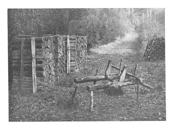
Abb. 4. Vom Holzhauer am Arbeitsplate verfertigter Wellenbinder
