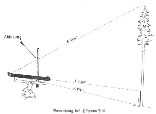
Das Visier auf der Augenseite besteht aus einem Schlitz und einem Faden, auf der Objektseite aus horizontalen, weißen Roßhaarfäden.
