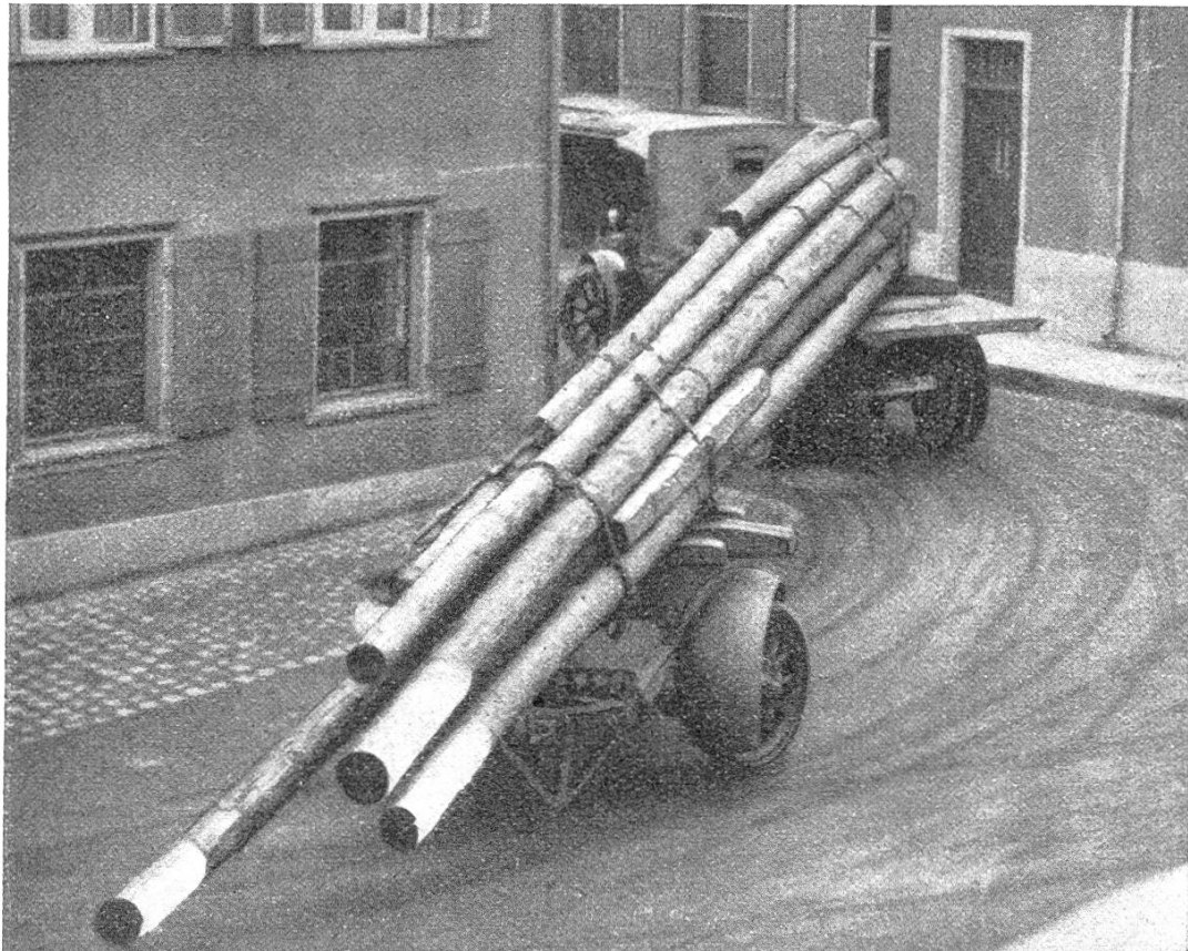
Saurer Langholztransportwagen. Der lenkbare Hinterwagen folgt der Spur des Vorderwagens und ermöglicht das Befahren scharfer Kurven.
