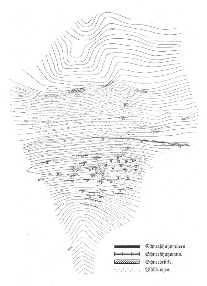
Fig. 10. Berbauung der Calcestri=Lawine, km 91,100/300. Maßstab 1:1000. Üquidistanz 5 m.
