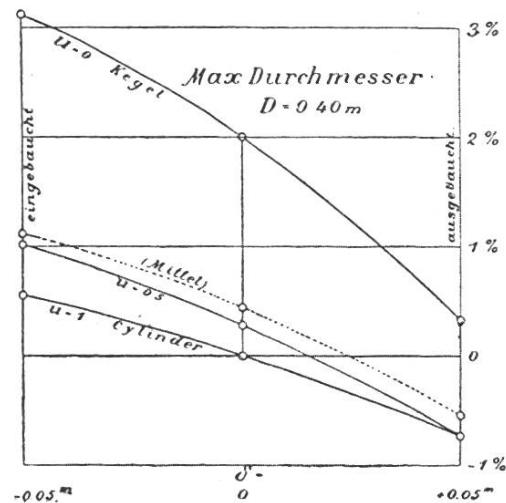
Unter Beibehaltung der Werte  $D = 0,40$  und  $\delta = 0, -0,05$  und  $+0,05$  haben wir auch noch die Rotationskörper mit  $u = 0$  und  $u = 1,0$  berechnet. Die Resultate sind in folgender Tabelle enthalten. Aus derselben, wie auch aus der graphischen Zusammenstellung der relativen Fehler  $100 \cdot \frac{V' - V}{V}$  (Fig. 4) geht hervor, daß bei der Stammkubierung aus den beiden Enddurchmessern — unter Annahme der Form
