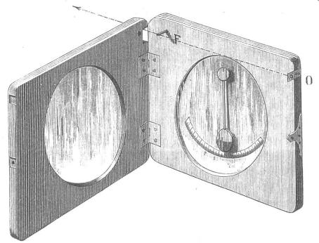
der Einrichtung an Boussolen) beweglich gemacht werden kann; alsdann je nach der Neigung ein Bruchtheil der 100theiligen Skala in Tangenteneinheit oder Prozenten angibt und dauernd fixirt — im Momente des Druckaufhebens.
