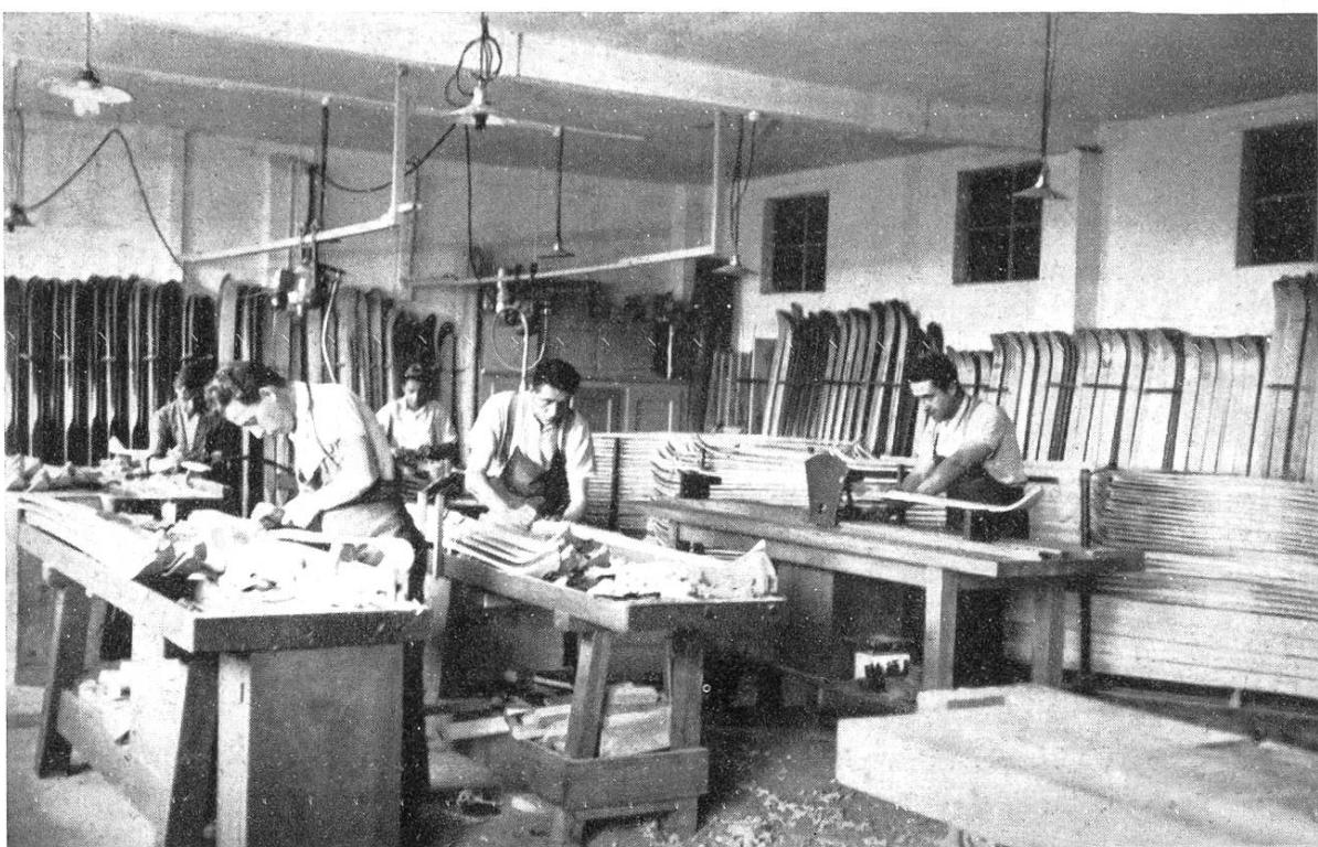
EQUILIBRAGE ET FINISSAGE DES SKIS; POSE DES ARÊTES.
