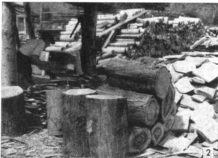
N° 2. Petites billes de peuplier prêtes à être déroulées. A l'arrière-plan, les cylindres qui restent après le déroulage et dont on tire parti pour renforcer les paniers. — Moderna S. A. Vernayaz.
