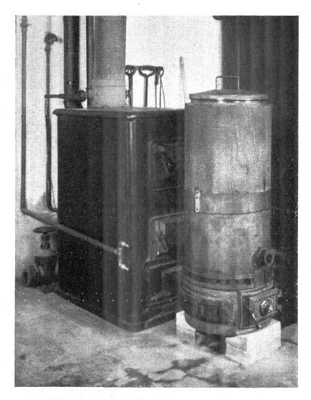
7. Brûleur à gaz (gazéification) pouvant s'adapter, tel un brûleur à mazout, à une chaudière quelconque (chauffage centraux, laiteries, etc.). La chaudière est alimentée par une flamme de gaz de bois.
