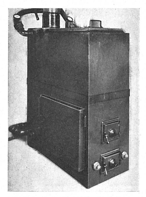
9. Chaudière gazogène à gazéification totale, longues bûches ou morceaux, feu renversé, grille à circulation d'eau et récupération de la chaleur radiante par l'air primaire. Les gaz sont flambés dans un corps de chauffe à lamelles concentriques, avec apport d'air chaud.
