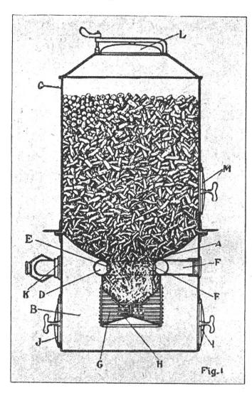
Fig. 12. Gazogène Berliet, fonctionnant au bois (système Imbert-Dietrich)
