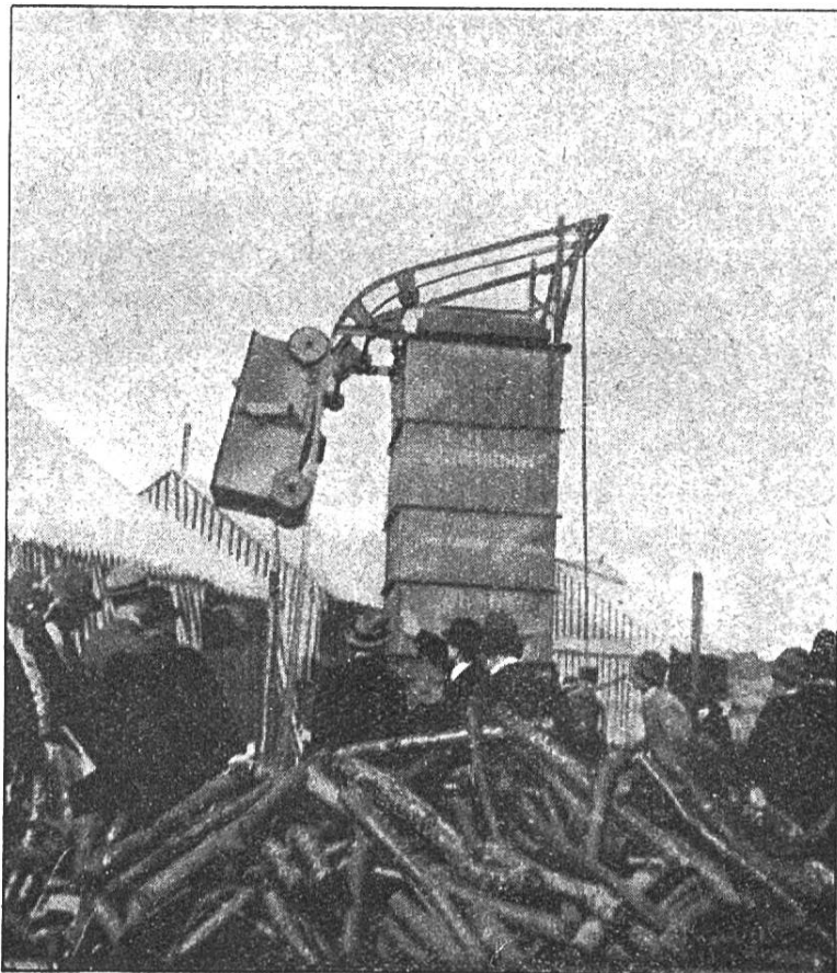
Fig. 10. Four à carboniser, système Auto-carbon, continu, à chargement mécanique.
