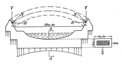
C'est une poutre chargée aux deux extrémités d'une réaction verticale V, d'une poussée horizontale H et d'un moment M. Ces efforts créent sur la partie inférieure du barrage certaines pressions. Si nous trouvons la loi d'après laquelle
