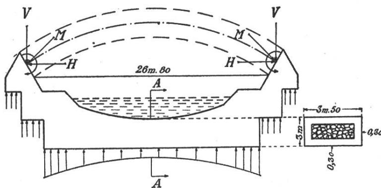
se répartissent ces pressions, notre problème sera résolu. L'auteur du projet a calculé ces pressions en se basant sur un terrain homogène. Le principe des recherches est celui-ci:
