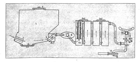
Fig. 2. Schéma du gazogène Berliet-Imbert, de l'armée française
