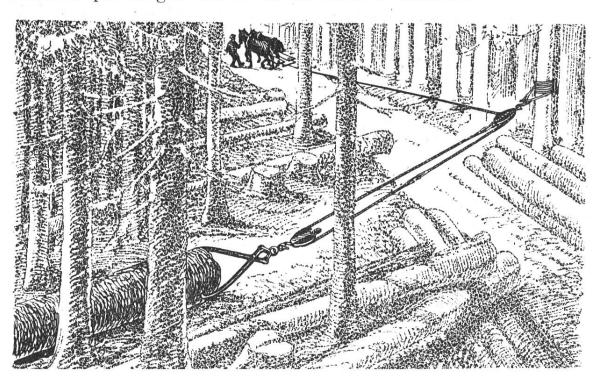
Fig. 1. C'est le cas le plus simple ; une seule poulie (R) dite de déviation fixée à un arbre (B) permet aux chevaux (Pf) de tirer la pièce de bois (St) jusqu'au chemin sans quitter celui-ci.
