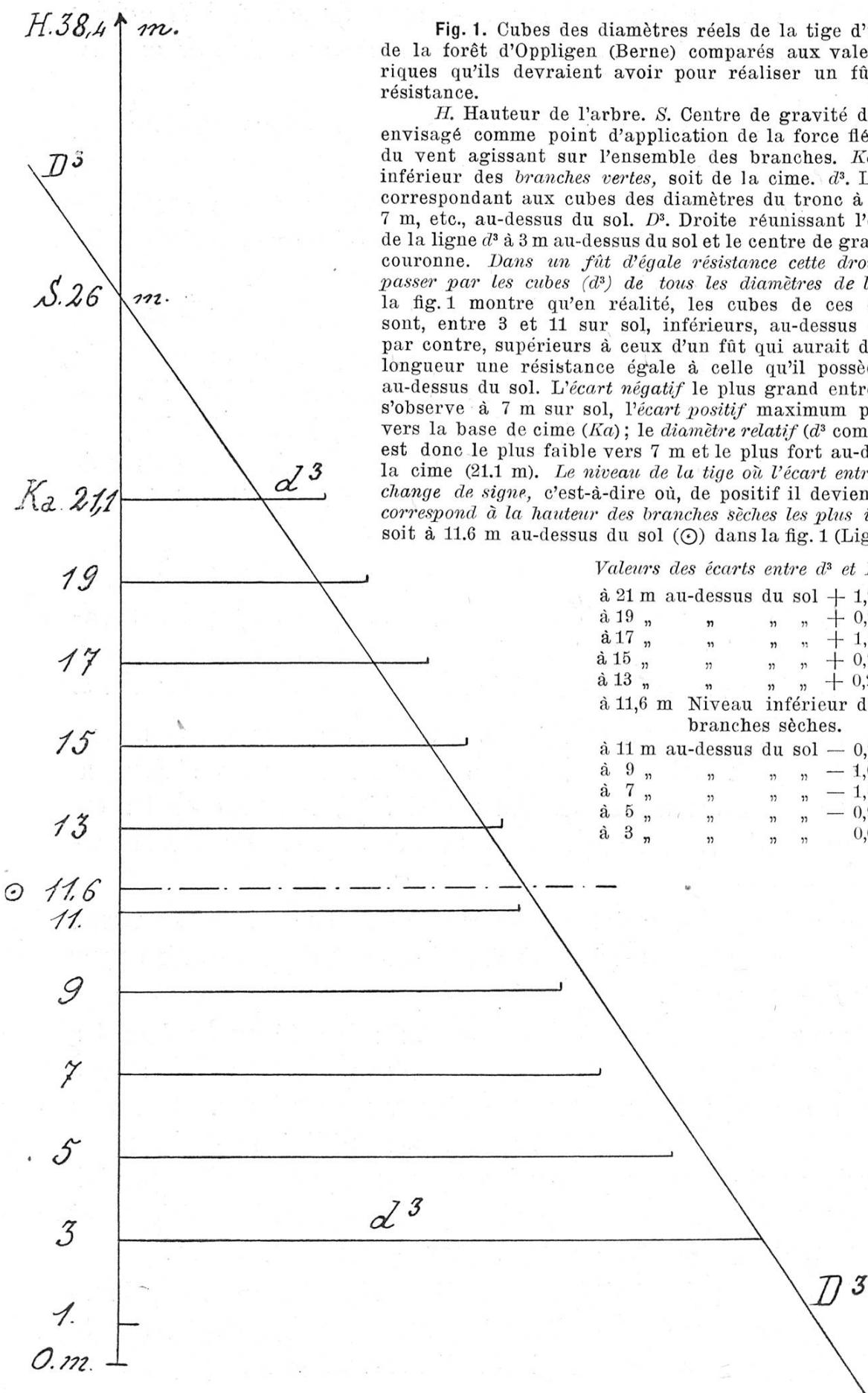
Fig. 1. Cubes des diamètres réels de la tige d'un épicéa de la forêt d'Oppigen (Berne) comparés aux valeurs théoriques qu'ils devraient avoir pour réaliser un fût d'égale résistance.
