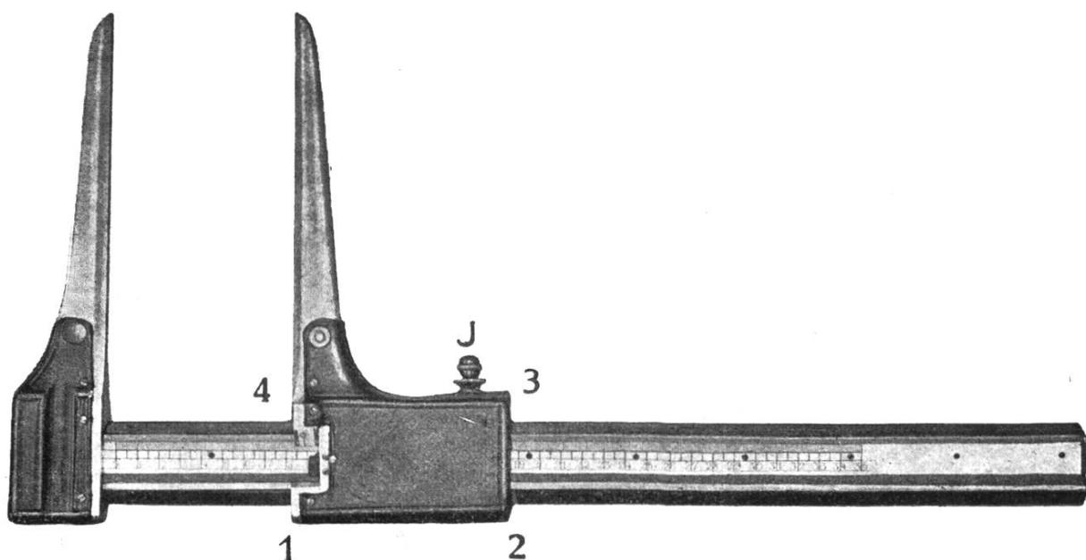
On règle le compas au moyen de la vis de réglage J. Le corps de celle-ci vient presser sur une plaque de laiton fixée à un fort ressort et peut ainsi faire varier à volonté l'ouverture pour le passage de la règle graduée.
