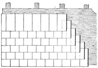
Fig. 4. Couverture à double recouvrement, ardoises rectangulaires.
