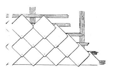
Fig. 3 Couverture à la française, avec ai ardoises tronquées à coins surplombants. A Ardoises de 15:15; 20:20; 25:25; 30:30; 40:40; 50:50 cm.
