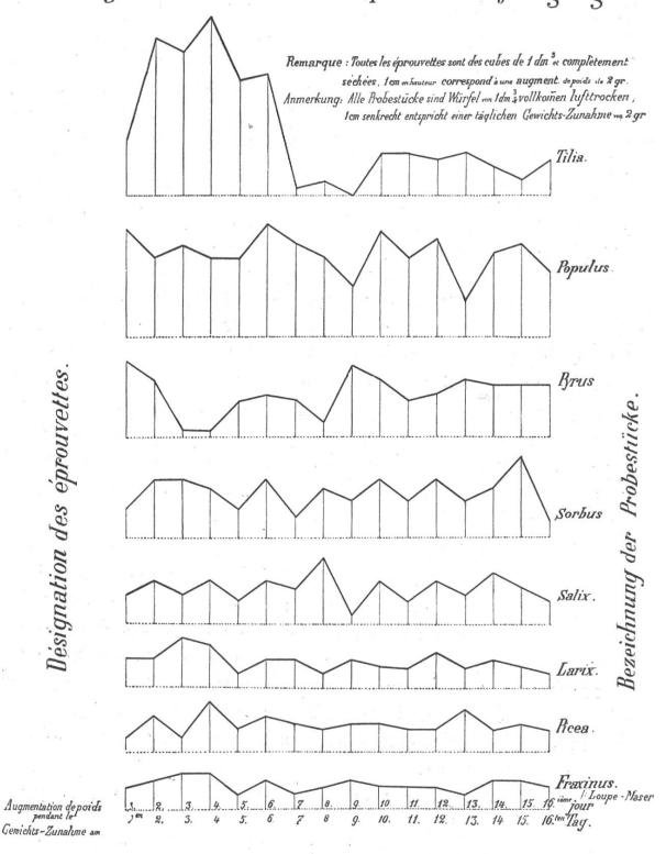
écarts puissent s'expliquer par des variations de température ou d'humidité de l'air du laboratoire.
