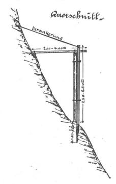
Fig. 9b. Coupe en travers d'un pont à neige, avec porteurs en rails. Echelle 1:200
