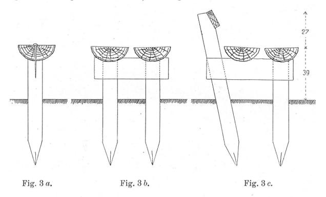
1,20 m de long et ils sont enfoncés obliquement dans le sol. Le siège est construit comme dans le cas précédent, et le dossier, formé d'une pièce de 3—4 cm d'épaisseur et de 12 cm de hauteur, est fixé comme le montre la fig. 3°. Un banc établi de la sorte coûte une dizaine de francs.
