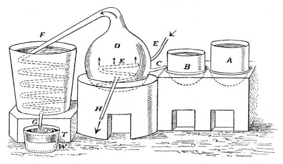
Fig. 4. Fabrication de la térébenthine par distillation.
