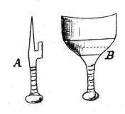
Fig. 1. Crampons servant à fixer la lame en zinc par l'écoulemeni de la résine. A coupe longitudinale, B coupe verticale,
