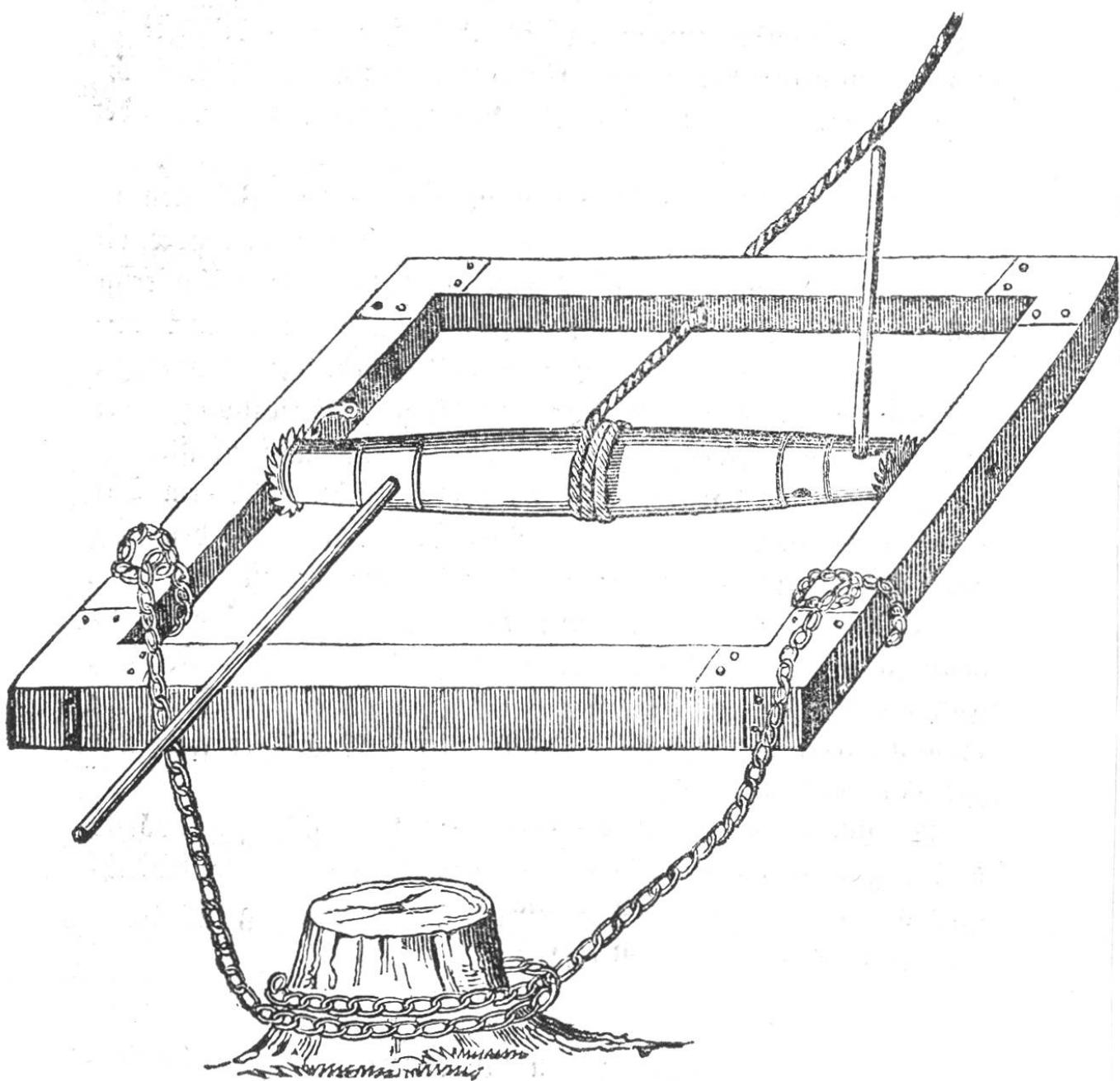
Beim Gebrauche wird dasselbe mittelst einer Kette an einen festen Gegenstand z. B. einen Stock befestigt und alsdann das Seil, welches an den zu fällenden Stamm gebunden wurde' mittelst Umdrehen der Walze angezogen. — Dieses Werkzeug ist sehr leicht transportabel und von so einfacher Konstruktion, daß die meisten Bestandtheile von den Holzhauern selbst angefertigt werden können.
