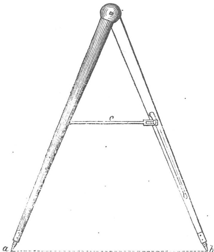
Fuß an den Spitzen durch ein eisernes Querstengelchen c festgestellt wird. Dieser Zirkel dient zum Messen der Längen, er kann bequem zusammengelegt unten mit einer anzuschraubenden Hülle versehen und als Gehstock benutzt werden. Zur Vertheidigung ist er dagegen nicht brauchbar, da durch die in seinem Holze eingelassene Nuthe für die Unterbringung des Eisen-
