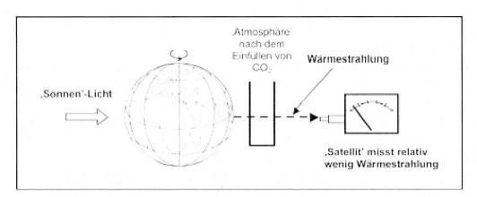
Abbildung 1: Schemaskizze des in der Experimentalgruppe 1 verwendeten Modellexperiments.
