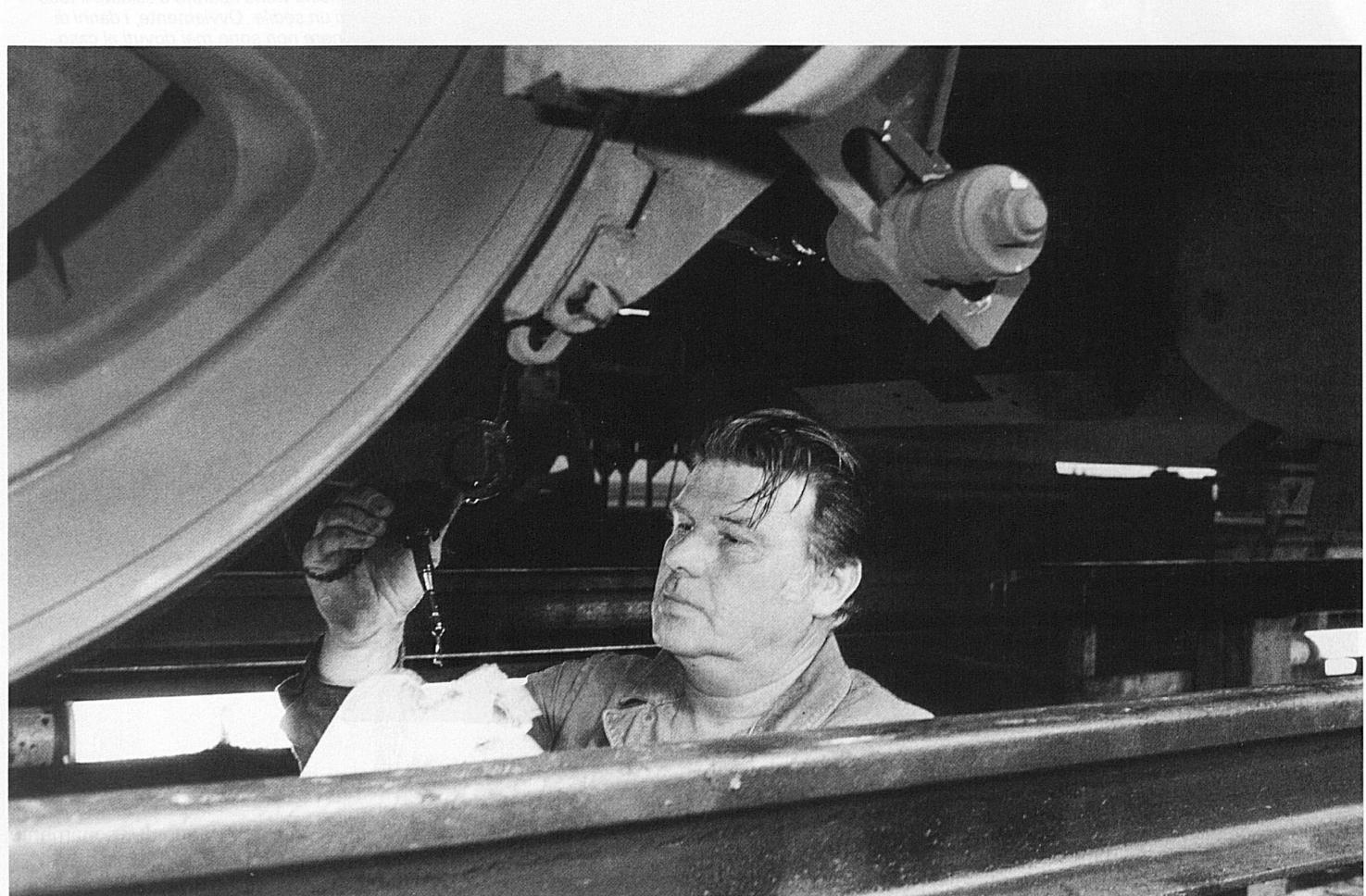
et même d'exécuter des travaux préventifs dans l'atelier approprié. Le «visiteur» procède à un contrôle systématique et complet de chaque wagon aussi bien dans les ateliers d'entretien que dans les gares ou sur les voies de triage. Cette surveillance technique vise en premier lieu à assurer la sécurité maximale de l'exploitation.
