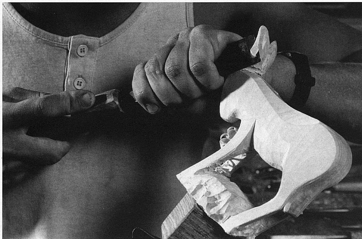
Müsste heute für eine Holzkrüppenfigur die ganze Arbeit ausschliesslich von Hand gemacht werden, ergäbe sich ein rund fünfmal höherer Preis des fertigen Produkts. Dank einer einfachen Schnitzlernmaschine – die Formen der Figur werden abgetastet und mechanisch auf eine Fräse übertragen – und anschliessendem «Finish» von Hand reduziert sich der Arbeitsaufwand beträchtlich.
