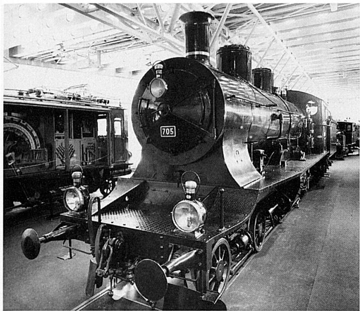
50 Schlepptender-Schnellzugslokomotive 2'C, Typ A 3/5, Nr. 705, SBB.
