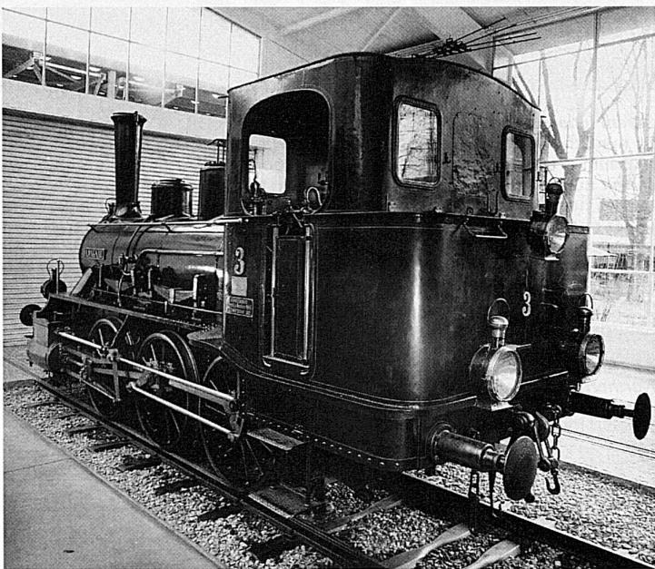
48 Tenderlokomotive C, Typ Ed 3/3, Nr. 3, «Langnau», Emmentalerbahn (EB). Schweizerische Lokomotiv- und Maschinenfabrik Winterthur (SLM) 1881. 280 PS, v<sub>max</sub> 50 km/h
