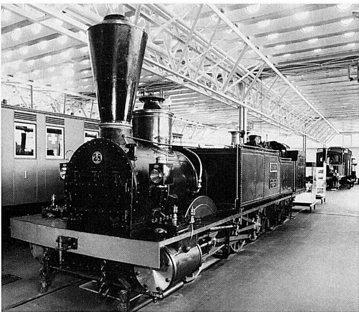
47 Stütztender-Lokomotive System Engerth B 3', Typ Ec 2/5, Nr. 28, «Genf», Schweizerische Centralbahn (SCB). Maschinenfabrik Esslingen, 1858. 400 PS, v<sub>max</sub> 60 km/h
