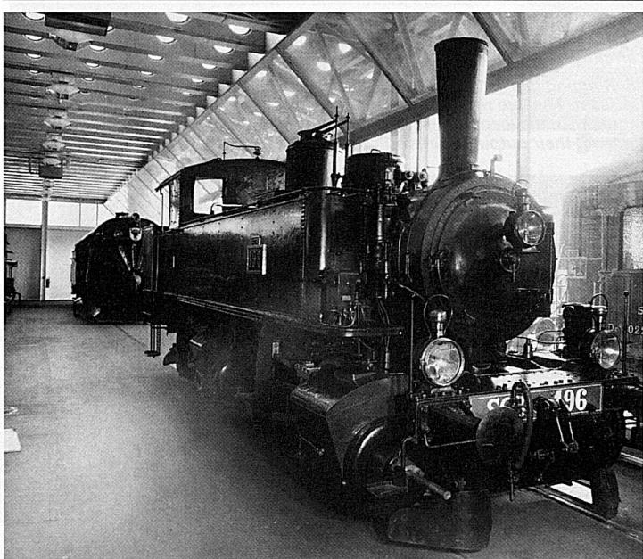
49 Tenderlokomotive System Mallet C4, Typ Ed 2x2/2, Nr. 196, SCB. Lokomotivfabrik Maffei München 1893. 700 PS, v<sub>max</sub> 55 km/h
