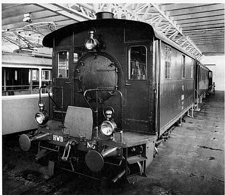
52 «Motorlokomotive» C, Typ Ec 3/3, Nr. 5, Huttwil-Wolhusen-Bahn (HWB).
