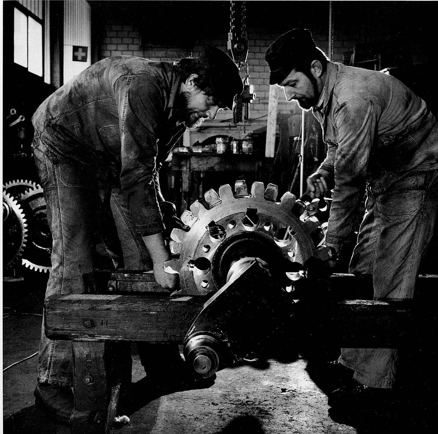
36 Die Achslager werden bei der alljährlichen Revision ausgemessen und je nach Zustand in der Werkstatt neu ausgegossen und gedreht.
