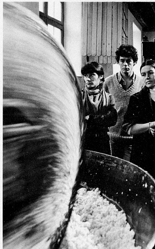
19 Der gestampfte, verdünnte Hadernbrei wird mit einem Drahtsieb aus der heizbaren Bütte geschöpft. Nach Abtropfen des Wassers bleibt eine dünne Schicht zurück, das Papierblatt. Es wird auf Filze abgelegt, dann gepresst.
