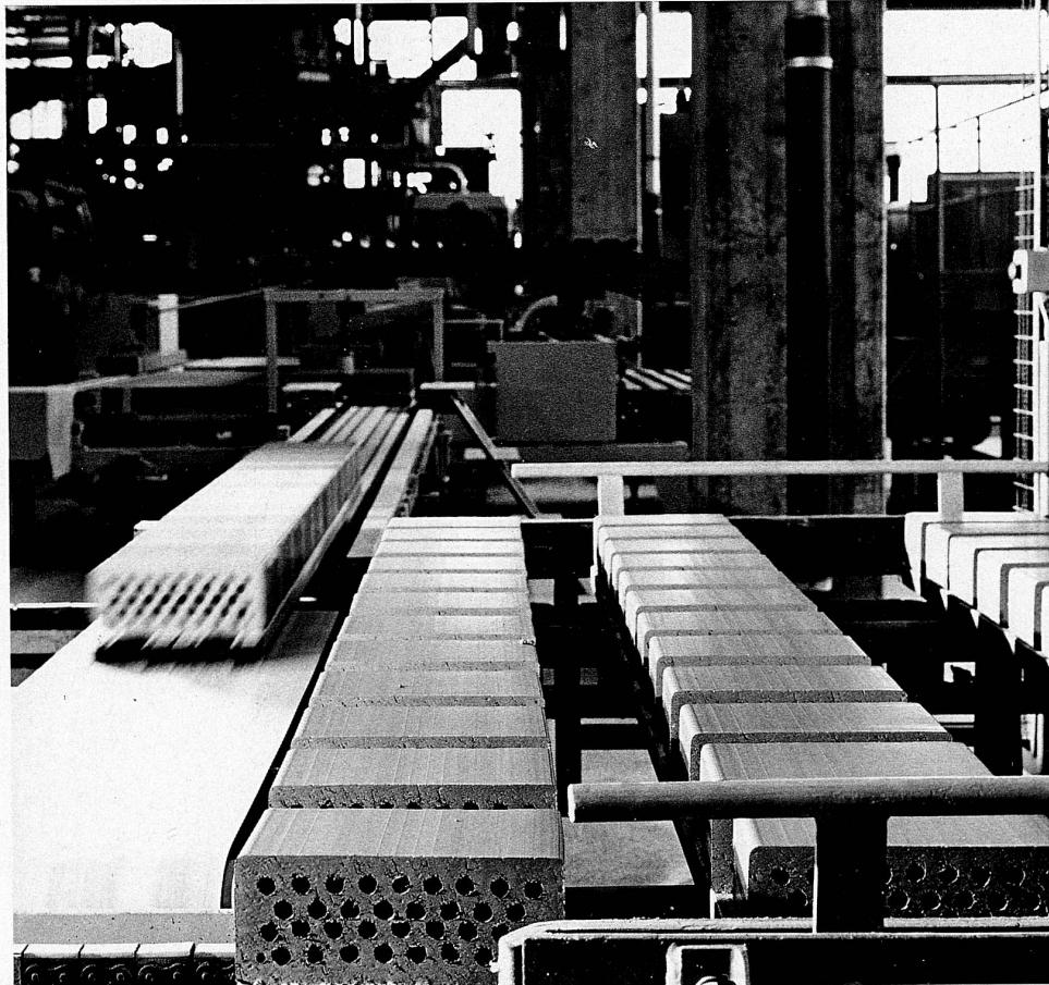
*Der Lehm wird in einer Strangpresse durch Mundstücke mit entsprechendem Kerneinsatz gepresst (hier erhält der Backstein seine Löcher) und gelangt als fortlaufender Strang auf den Abschneidetisch, wo mit einem Draht Steine von der gewünschten Dicke automatisch abgeschnitten werden (45).*
