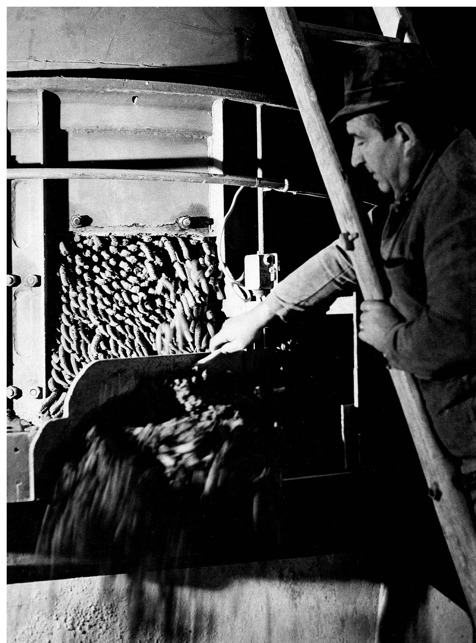
42 Der Siebrundbeschicker komprimiert und kneift den Lehm unter Zugabe von Wasser, damit der die nötige Plastizität für die Formgebung erreicht.
