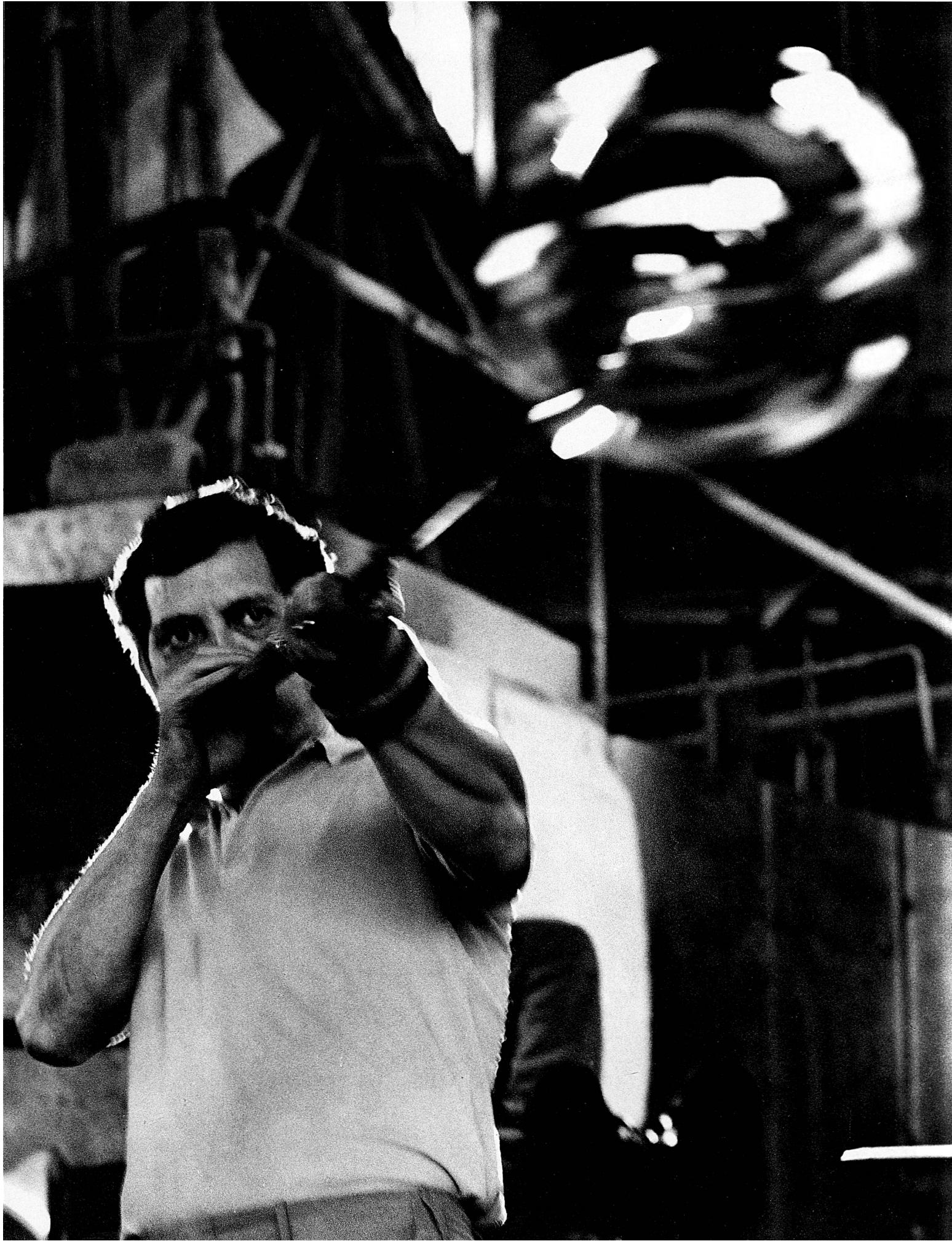
**10** Nachdem die geformte Kugel durch thermischen Schock von der Pfeife geschlagen wurde, erwärmt man den Abschnitt mit einer Flamme und bringt auf der Öffnung einen weiteren Posten Glas an.
