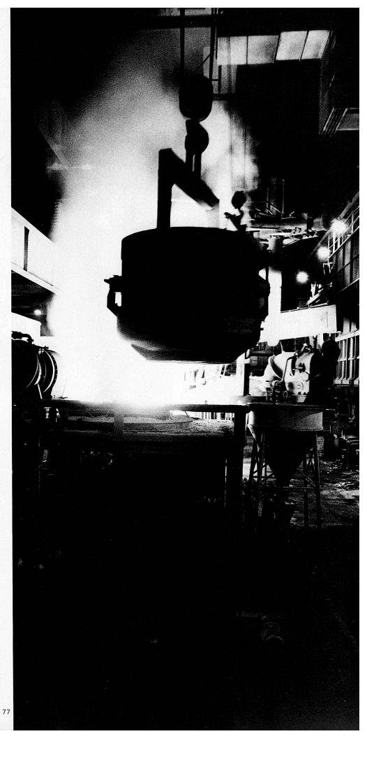
Rohstahl entsteht durch regenerierendes Umschmelzen von Schrott im Lichtbogenofen. Dieser besteht aus einer kippbaren, runden, feuerfest ausgemauerten Öfenwanne, die 50 Tonnen Schrott aufnehmen kann. Durch den abnehmbaren Deckel ragen drei Graphitelektroden, durch welche die elektrische Energie mit niedriger Spannung, aber sehr hoher Stromstärke in den Öfen gelangt. Zwischen Elektrodenspitzen und Schrott bildet sich ein Lichtbogen, dessen Wärme diesen zum Schmelzen bringt
