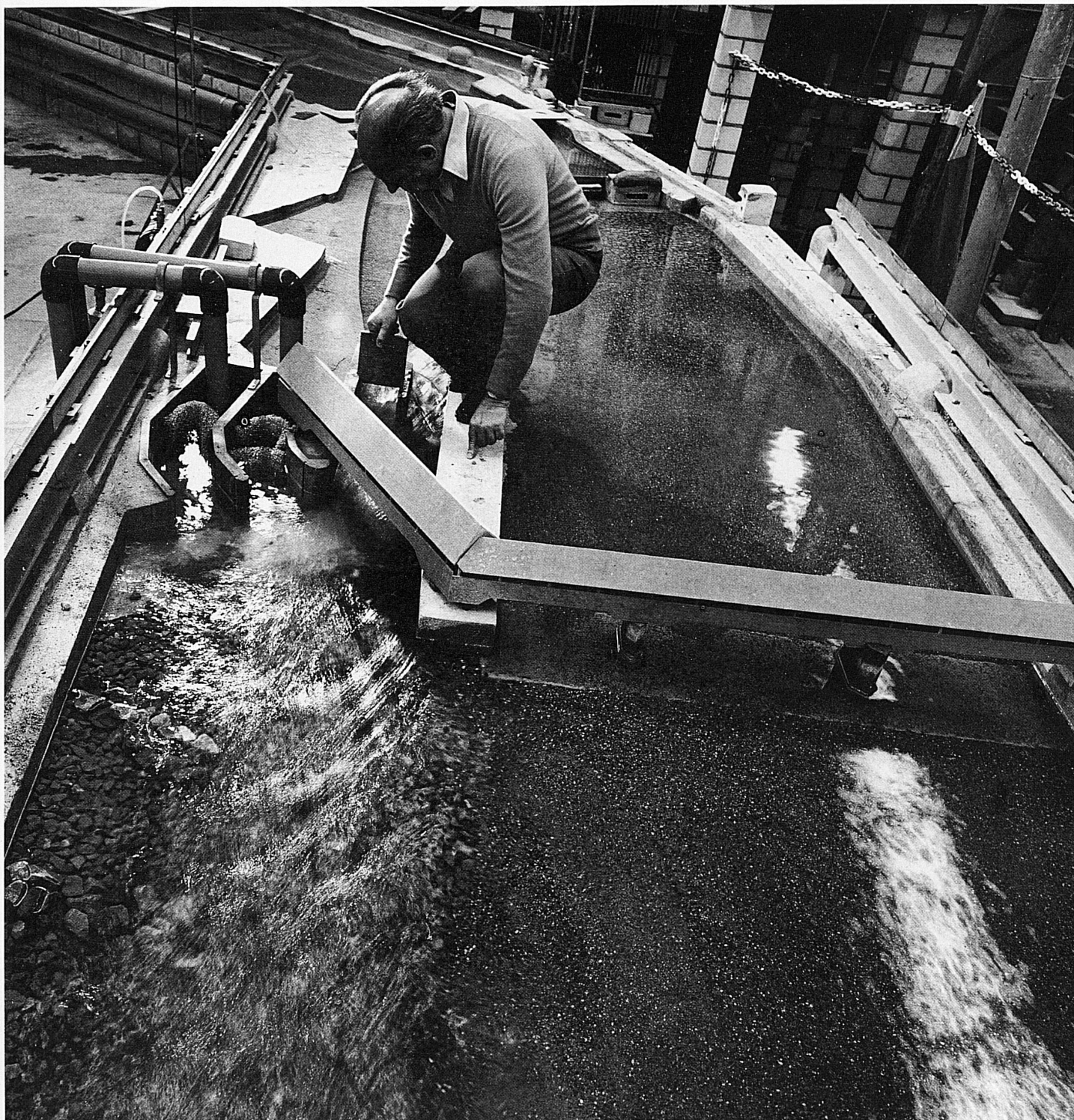
5 Stauanlage El Cajón in Honduras. Speicher für eine Wasserkraftanlage. Modell der höchsten Bogenstaumauer in Lateinamerika im Massstab 1 : 100 zum Studium der Hochwasserentlastung und der Grundablässe (Öffnen der Schützen bei der Hochwasserumleitung). 6 Umbau und Ergänzung des Reusswehrs in Luzern zur Verbesserung der Regulierung des Seespiegels im Vierwaldstättersee und zur Verhinderung von Uferüberschwemmungen. Modell im Massstab 1 : 40
