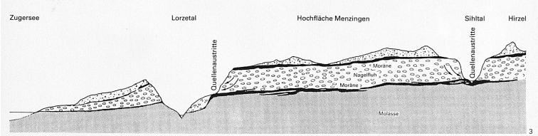
Geologisches Profil Lorzetal-Sihltal. Die über der Molasse liegenden Schichten aus meist durchlässigem kiesigem und sandigem Material sind bis zu 300 m stark und gewähren eine intensive Filtration des Niederschlagswassers
