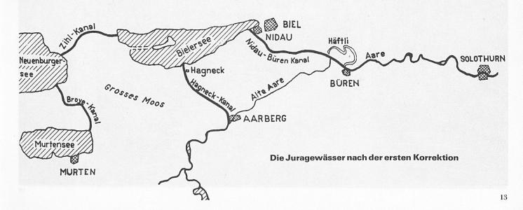
Trockenlegung der versumpften Gebiete; Erstellung eines durch Schleusen regulierten Abflusskanals aus dem Bielersee anstelle des gewundenen Zihllaufs zwischen Nidau und Büren.
