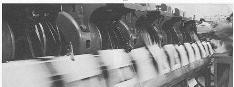
13 Der Druck erfolgt im Flachdruck-verfahren (Offsetdruck) mit umsteuerbaren Maschinen für den ein- und mehrfarbigen Druck, mit Kontrollelementen zur Überwachung und Steuerung der Qualität des Passers und der Farbgebung
